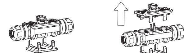
Stecken Sie das AC-Hauptkabel in den T-Stecker .T-Stecker festziehen.
