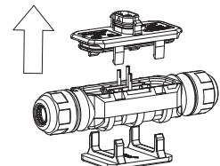
Insira o cabo tronco AC no conector T . Aperte o conector T.
