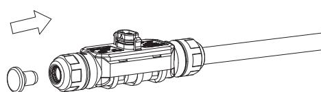
Conekte o cabo tronco AC à caixa de distribuição ou à caixa de junção.
