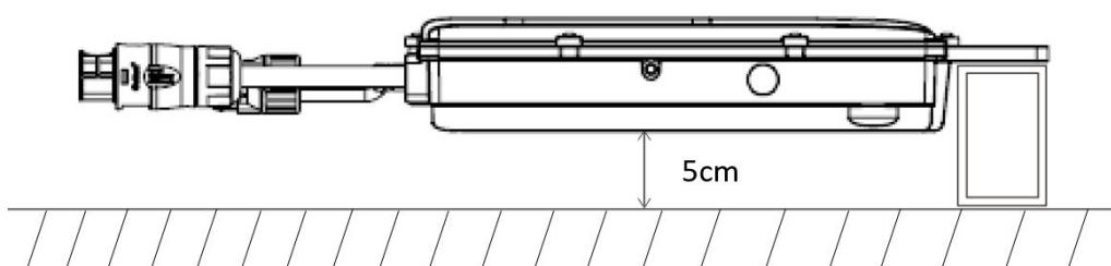
Escolha a melhor posição de instalação. Usando dois pares de parafusos e porcas, fixe o microinversor na estrutura. Certifique-se de que a etiqueta frontal do microinversor esteja para cima.
