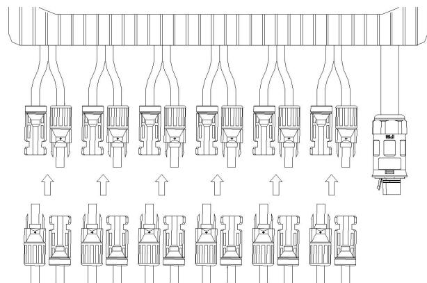
Usando o microinversor TSOL-MP3000, cada entrada DC pode conectar dois módulos em série.
