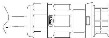
Ligue o conector AC ao microinversor e ligue o cabo AC à caixa de distribuição AC.
