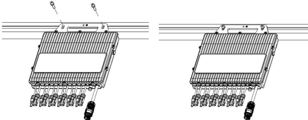
O microinversor também pode ser instalado na parede (vertical). Fixe o suporte (opcional) na parede com os parafusos apropriados. Em seguida, usando dois pares de parafusos e porcas, fixe o microinversor no suporte. Certifique-se de que a etiqueta frontal do microinversor esteja para o lado de fora.
